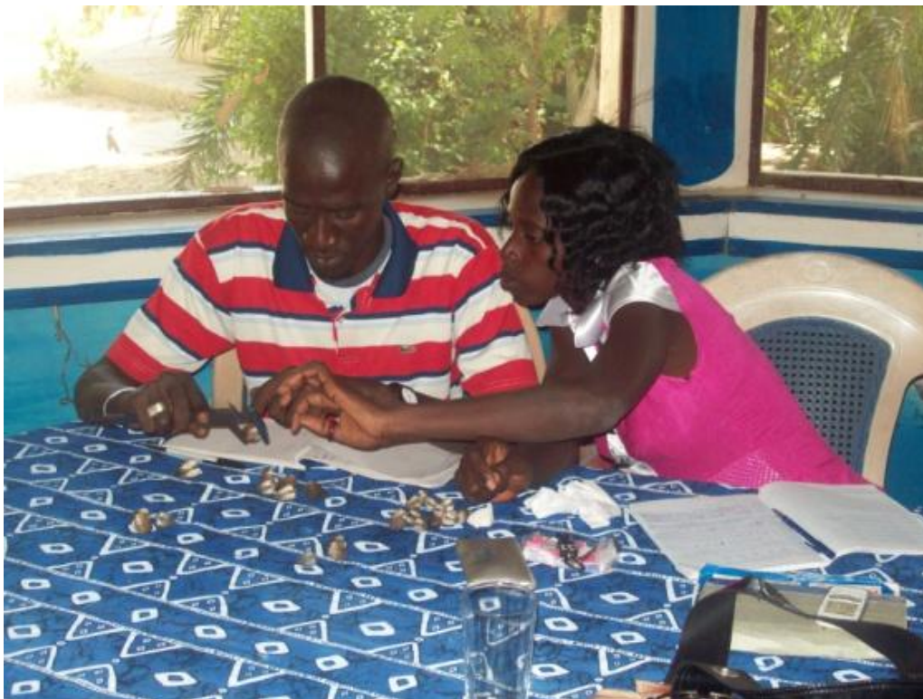
Mesure des échantillons avec le pied à coulisse
