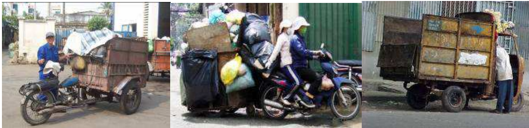
Tricycle motorisé – Remorque auto-conçue – Voiture à 3 roues
