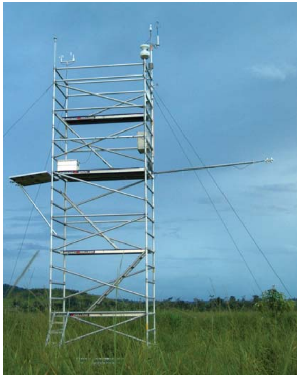
Puits de carbone au Brésil : tour de mesure de flux de CO 2 sur le site de reboisement.
